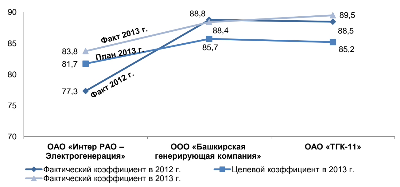
Рис. 9. Коэффициент готовности генерирующего оборудования в 2013 г. превысил значение показателя 2012 г., а также целевое значение на 2013 г.
